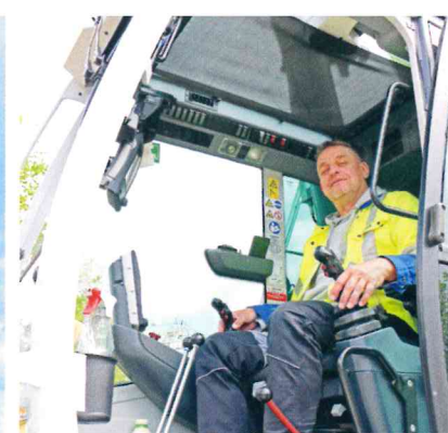
Maschinist Soltan Szüsz (Firma PORR) schätzt die Qualitäten des Multitasking-Meister Sennebogen 673 E: Lasten drehen, schwenken, verfahren, heben, punktgenau absetzen und das Ganze in Schräglage. Möglich durch 360°-Schwenks, stufenloses Teleskopieren und Verfahren mit bis zu 100% Last.
